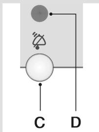
При превышении допустимой температуры включается звуковая сигнализация (**прерывистый сигнал**) и мигает красная лампочка **D**.
