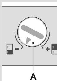
С помощью ручки **A** выберите отделение аппарата, температуру которого вы хотите видеть на дисплее и температуру которого можете установить с помощью кнопки **E**. При выборе отделения аппарата убедитесь, что стрелка ручки указывает на обозначенную область.
