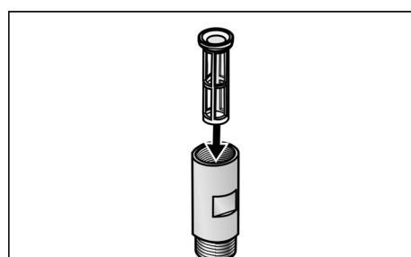
2. Вставьте уплотнитель в корпус фильтра и подсоедините к водопроводному крану (резьбовое соединение  $\frac{3}{4}$ ").
