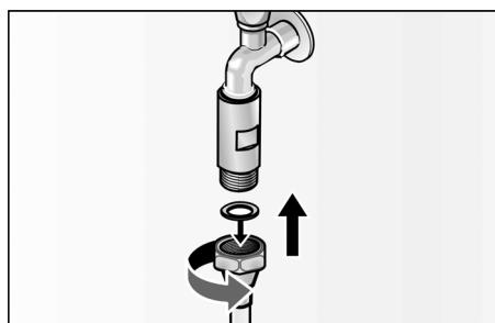
4. Осторожно открыть водопроводный кран и проверить при этом герметичность соединений.
