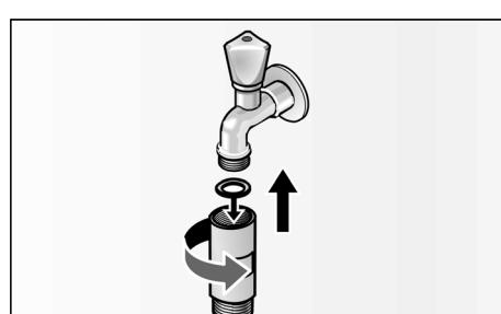
3. Присоединить шланг подачи воды с уплотнителем с помощью вилочного гаечного ключа к корпусу фильтра (если он не был вмонтирован на заводе).
