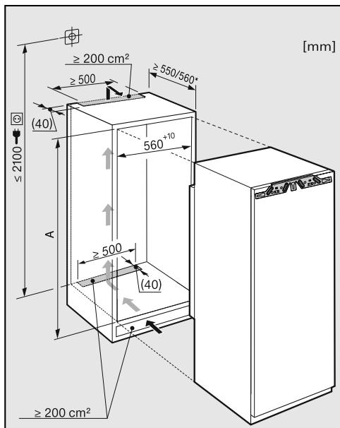
\* Заявленное потребление электроэнергии рассчитано для глубины ниши 560 мм. В нише глубиной 550 мм прибор будет полностью работоспособен, однако, у него будет немногого более высокое энергопотребление.
