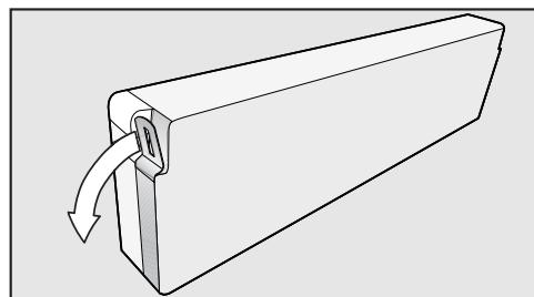
■ Возьмитесь за конец пластины и вытяните его с полки. Затем отделяйте всю пластину от полки.
