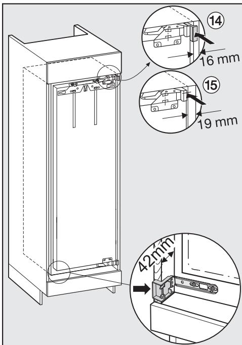
**Важно для мебели с такими деталями ограничителя хода двери, как утолщения, уплотнения и т.п.:** Чтобы и здесь было соблюдено расстояние по периметру в **42 мм**, должен быть также учтён конструктивный размер этих деталей.
