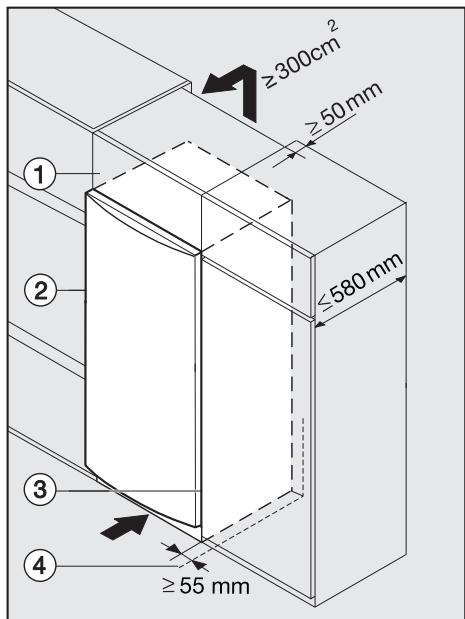
\* У приборов со смонтированными проставками глубина прибора увеличивается прим. на 35 мм.
