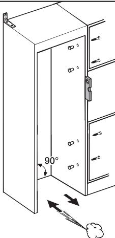
Перед встраиванием прибора следует выполнить тщательное выравнивание мебельного шкафа с помощью уровня. Все углы шкафа должны составлять  $90^\circ$ , так как иначе дверца не будет прилегать со всех 4 углов.
