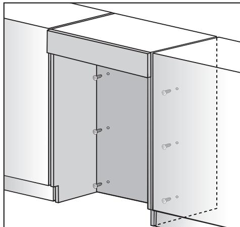
■ привинтите заднюю стенку шкафа в нескольких местах непосредственно к лежащей за ней стене. Для этого используйте, в зависимости от материала стены, подходящие дюбели/крепежные шурупы.
