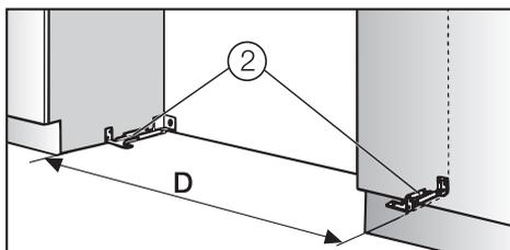
Расстояние "D" между креплениями ② в точности соответствует ширине прибора.
