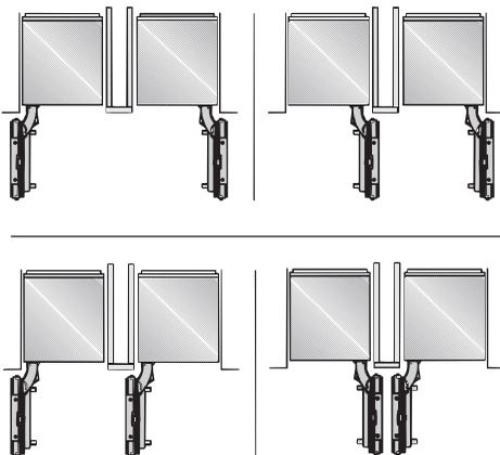
Если между приборами, расположенными рядом, есть промежуточная стенка толщиной **между 16 мм и 160 мм**, то приборы поочередно крепятся прилагаемыми монтажными материалами в нишу. Дополнительно потребуется монтажный комплект Side-by-side.
