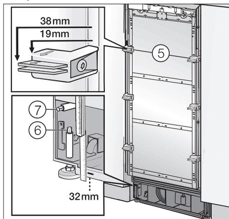
Вспомогательные установочные элементы ⑤ на дверце прибора рассчитаны на толщину мебельного фронта 19 мм или 38 мм.
