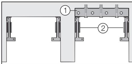
Если ниша глубже, чем прибор, установите массивную деревянную балку ① сзади крепления от опрокидывания ② и прикрепите ее к полу или к стене.
