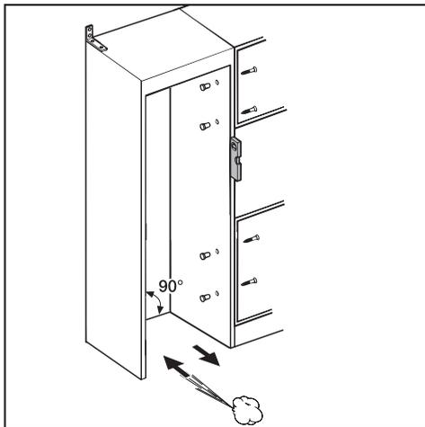
Перед встраиванием прибора следует выполнить тщательное выравнивание мебельного шкафа с помощью уровня. Все углы шкафа должны составлять  $90^\circ$ , так как иначе дверца не будет прилегать со всех 4 углов.
