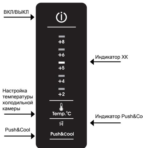
**ВКЛ/ВЫКЛ** - нажатием данной кнопки можно включить весь прибор в целом (как холодильную, так и морозильную камеры). Для отключения холодильника достаточно нажать кнопку.
