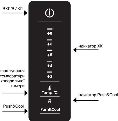
**ВКЛ/ВИКЛ** - натисканням цієї кнопки можна включити весь прилад в цілому (як холодильну, так і морозильну камери). Для відключення холодильника достатньо натиснути кнопку.
