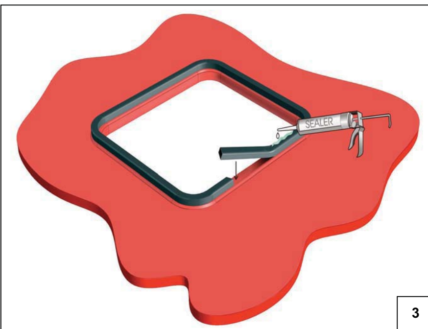
Наклеить по периметру отверстия уплотнитель
