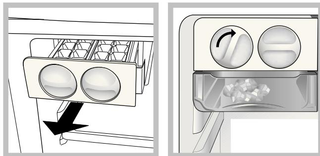
Ked' potrebujete viac skladovacieho priestoru, MISKU NA ĽAD je možné vyložiť zatlačením klipsy na hornej strane misky.
