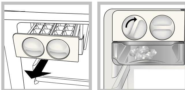
Om du behöver mer lagringsutrymme kan du ta ut ISANORDNINGEN genom att trycka på haken ovanpå isanordningen.
