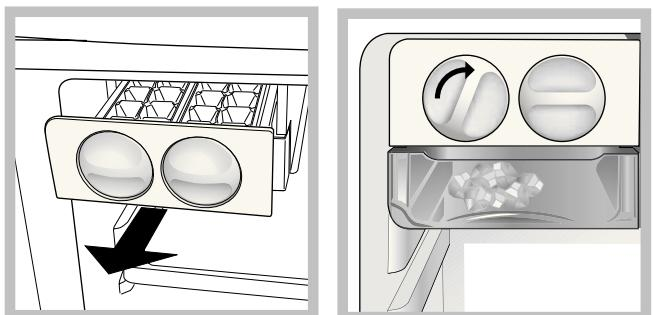
Ako vam treba više prostora za pohranu, možete izvaditi NAPRAVU ZA LED tako da gurnete pričvršćivač na vrhu naprave za led.
