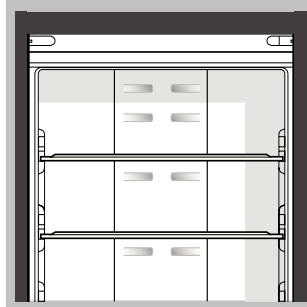
No Frost zagotavlja neprekinjen dotok hladnega zraka, ki pobira vlago in preprečuje nastajanje ledu in ivja: v hladilniku vzdržuje pravilni nivo vlažnosti in, ker ni ivja, živila ohranijo svojo prvotno kakovost; v zamrzovalniku preprečuje nastajanje ledu, zaradi česar odtajevanje ni potrebno, in preprečuje sprjemjanje živil.
