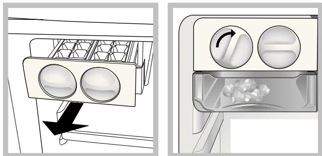
Если Вам требуется больше места, Вы можете вынуть УСТРОЙСТВА ДЛЯ ПРИГОТОВЛЕНИЯ ЛЬДА, нажав на гвоздик в крышке устройства.
