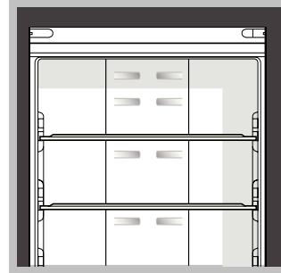
Det elektroniske nedkjølingssystemet Surround No Frost kjenner man igjen på grunn av luftcellene som finnes på øvre del av veggene i kjølerommet. Systemet Surround No Frost gjør det, takket være de mange luftcellene, mulig å oppnå en konstant luftsirkulasjon og dermed få jevn temperatur i hele kjølerommet fordi ventilasjonen er ensartet i hele rommet. No frost styrer en kontinuerlig strøm av kald luft som samler opp fuktighet og hindrer danning av is eller rim:
