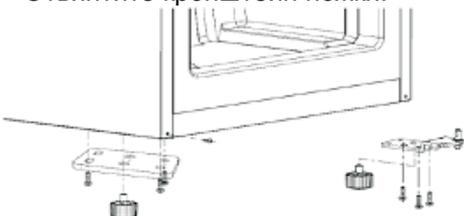
5. Извлеките ось из петли дверцы и вставьте ее с другой стороны петли. Затем привинтите петлю дверцы с другой стороны изделия, после чего привинтите отдельный кронштейн ножек на соответствующей противоположной стороне. Снова привинтите обе ножки.
