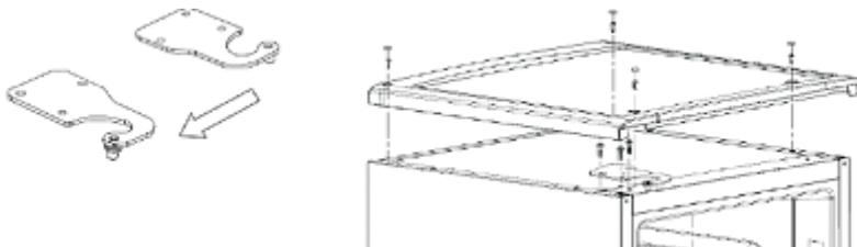
Наденьте снятую в пункте 1 крышку, затяните винты и наденьте колпачки.
