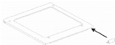
3. Снимите верхнюю петлю, выкрутив ее винты. Приоткройте дверцу холодильника и осторожно снимите ее с нижней петли. Наденьте колпачок дверцы В на паз противоположной стороны А и положите дверцу на мягкую поверхность, чтобы избежать появления царапин.
