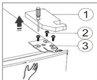
Lösen Sie die Schrauben (2) und entnehmen Sie das obere Türscharnier (3).
