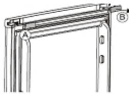
4. Извлеките два винта с буртиком средней петли. Снимите дверцу морозильника с нижней петли и также положите на мягкую поверхность. Вставьте колпачки крышки холодильника в противоположные отверстия.
