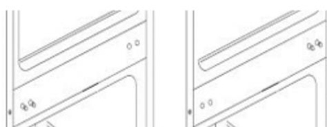
5. Наклоните изделие немного назад и зафиксируйте в этом положении. Отвинтите ножки и снимите кронштейн ножки и петлю дверцы, ослабив винты. Отвинтите ось и вставьте ее с другой стороны петли. Привинтите кронштейн ножки и петлю дверцы на противоположных сторонах и затем снова привинтите ножки.
