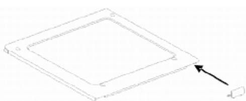
3. Демонтируйте верхнюю петлю, сняв ее крышку и выкрутив винты. Приоткройте дверцу холодильника и осторожно снимите ее со средней петли. Наденьте колпачок дверцы В на паз противоположной стороны А и положите дверцу на мягкую поверхность, чтобы избежать появления царапин.
