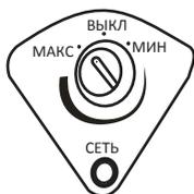
Панель управления представлена ручкой термостата и индикатором зеленого цвета. Зеленый индикатор на панели управления означает, что ларь включен в сеть. Регулировка температуры осуществляется с помощью термостата в пределах от  $-15^{\circ}\text{C}$  до  $-28^{\circ}\text{C}$ .
