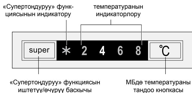
3-сүрөт – Башкаруу панели
