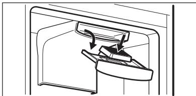
Для обеспечения оптимальной работы угольного воздушного фильтра, его следует ежегодно заменять.
