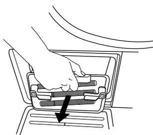
**4.** Промойте нижний фильтр под проточной водой, удалите с него пыль и пух.
