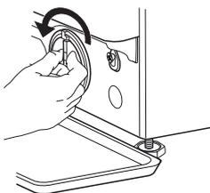
1. Снимите фильтр: Разместите под фильтром тряпку для сбора небольших остатков воды. Снимите фильтр, вывинтив его в направлении против часовой стрелки.
