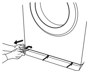
2. Емкость для слитой воды: Установите низкую и широкую емкость под фильтр воды для сбора в нее оставшейся воды.
