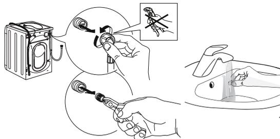
4. Установите сетчатый фильтр на место. Подсоедините заливной шланг к крану подачи воды и стиральной машине. Для подсоединения шланга не используйте инструменты. Откройте кран подачи воды и проверьте герметичность всех соединений.
