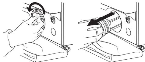
2. Очистите фильтр: Удалите твердые загрязнения и промойте фильтр в проточной воде.
