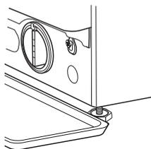
3. Слейте воду: Медленно поворачивайте фильтр против часовой стрелки до тех пор, пока не выльется вся вода. Дайте воде стечь, не снимая фильтр. Когда емкость наполнится, закрутите фильтр воды по часовой стрелке. Слейте воду из емкости. Повторите эту процедуру несколько раз до полного слива воды.
