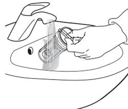
3. Вставьте фильтр и установите на место нижнюю панель: Вставьте фильтр, закрутив его в направлении по часовой стрелке. Убедитесь, что фильтр закручен до упора: ручка фильтра должна располагаться вертикально. Для проверки герметичности фильтра можно налить примерно 1 литр воды в лоток для моющих средств. Затем установите на место нижнюю панель.
