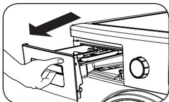
• Нажмите на указанный ниже участок внутри выдвигающего ящика для моющего средства, которое вы полностью вытянули на себя, и продолжайте вытягивать и снимать выдвигающий ящик со своего места.
