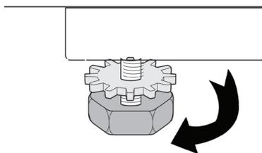
Вы можете отрегулировать равновесие машины с помощью регулируемой ножки.
