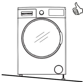
Вы можете отрегулировать равновесие машины с помощью соответствующего устройства сверху.
