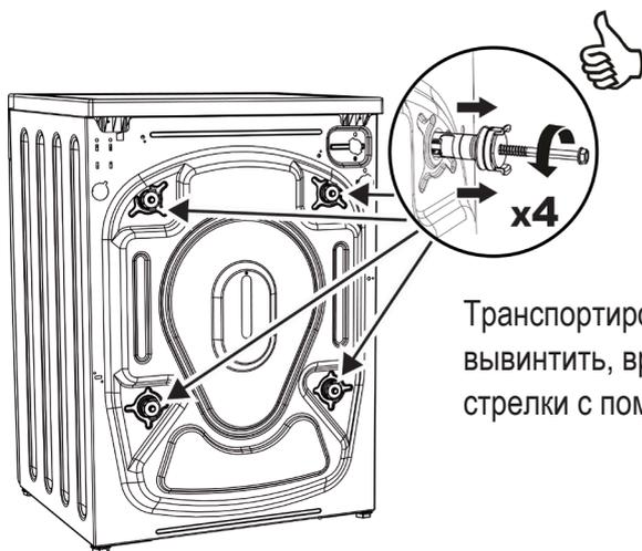
Транспортировочные болты необходимо вывинтить, вращая их против часовой стрелки с помощью подходящего ключа.
