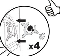
Установите заглушки вместо транспортировочных болтов в проемы, оставленные после извлечения болтов (находятся в пакете с дополнительными принадлежностями).
