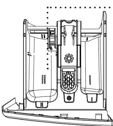
**Главный отсек моющего средства для стирки:** В этом отсеке используются только жидкие моющие средства и стиральные порошки или хлорсодержащие средства. Устройство для жидкого моющего средства находится внутри машины, вы можете найти его там при выполнении первичной настройки. (\*)
