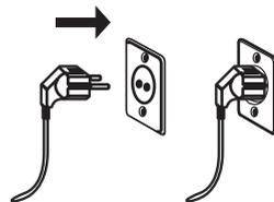
• Штепсельная вилка всегда должна вставляться в заземленную розетку с силой тока 10 ампер. Номинальный ток плавкой вставки сети питания, к которой подключается штепсельная вилка, также должен составлять 10 ампер.
