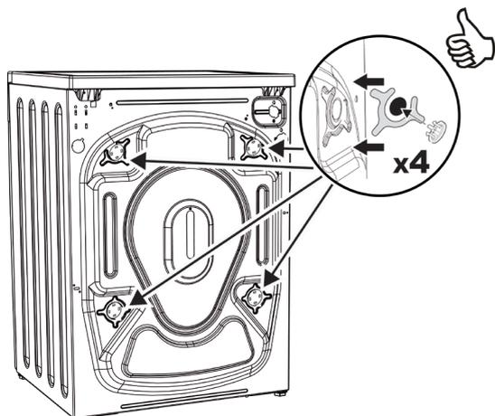
Установите заглушки вместо транспортировочных болтов в проемы, оставленные после извлечения болтов (находятся в пакете с дополнительными принадлежностями).
