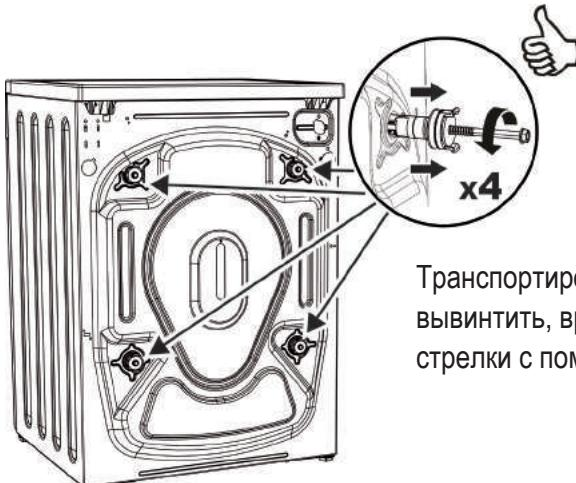
Транспортировочные болты необходимо вывинтить, вращая их против часовой стрелки с помощью подходящего ключа.
