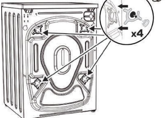
Установите заглушки вместо транспортировочных болтов в проемы, оставленные после извлечения болтов (находятся в пакете с дополнительными принадлежностями).
