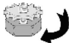
Вы можете отрегулировать равновесие машины с помощью регулируемой ножки.
