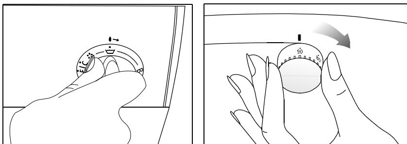
Поверните ручку термостата по часовой стрелке и установите ее на нужную температуру. Если ручка установлена на значок холодной воды, то стирка производится при температуре водопроводной воды. При необходимости можно включить режим половинной загрузки и/или режим остановки после полоскания. Поместите стиральный порошок и умягчитель в соответствующие отделения распределителя и закройте его.
