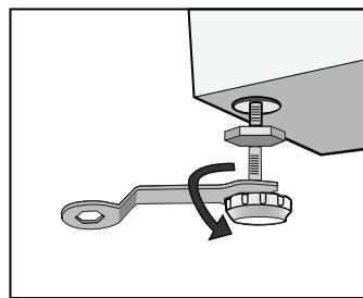
**После установки стиральной машины необходимо обязательно проверить горизонтальность ее положения и устойчивость. Для этого нужно надавить на каждый угол машины и убедиться, что она ни на одном из углов не качается!**
