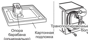
Снимите транспортировочные болты и опоры.
