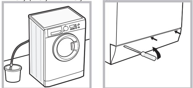
2. проверите да ли је ниво воде унутар машине испод нивоа отвора; у супротном извуците вишак воде кроз испушно црево сакупљајући је у кофу као што је показано на слици.
