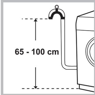
Pripojte vypúšťaciu hadicu k odpadovému potrubiu alebo k odpadu v stene, nachádzajúcom sa od 65 do 100 cm nad zemou; jednoznačne zamedzte jej ohybu.
