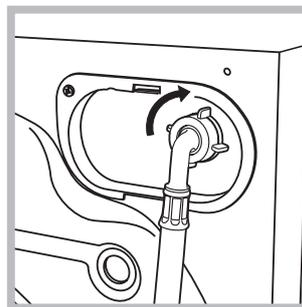
2. Pripojte prítokovú hadicu k práčke, jej zaskrutkovaním k príslušnej prípojke na vodu, umiestnenej vpravo hore (vid' obrázok).
