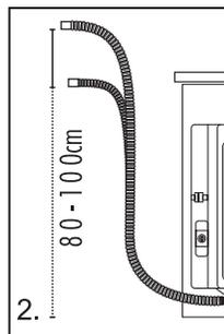
**!** Сливной шланг нельзя погружать в воду, его следует надежно закрепить и следить за отсутствием утечек. Если сливной шланг лежит на земле или высота трубы для слива составляет менее 80 см, вода из стиральной машины во время наполнения будет непрерывно сливаться (самостоятельный слив).
