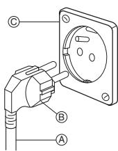
В целях вашей личной безопасности машина должна быть заземлена. Стиральная машина имеет шнур питания (A) с заземляющей вилкой (B). Для снижения риска поражения электрическим током вилку нужно вставлять в подходящую стенную розетку с заземлением (C). Если розетки с заземлением нет, пользователь обязан обратиться к квалифицированному электрику для установки стенной розетки с заземлением.
