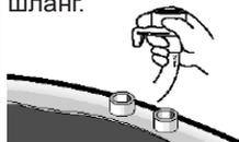
Выньте фильтр клапана налива воды.
