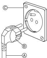
В целях вашей личной безопасности машинка должна быть заземлена. Стиральная машинка имеет шнур питания (A) с заземляющей вилкой (B). Для снижения риска поражения электрическим током вилку нужно вставлять в подходящую стенную розетку с заземлением (C). Если розетки с заземлением нет, пользователь обязан обратиться к квалифицированному электрику для установки стенной розетки с заземлением.
