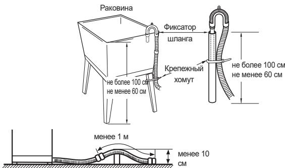
При подсоединении сливного шланга к раковине или баку хорошо закрепите его с помощью крепежного хомута.
