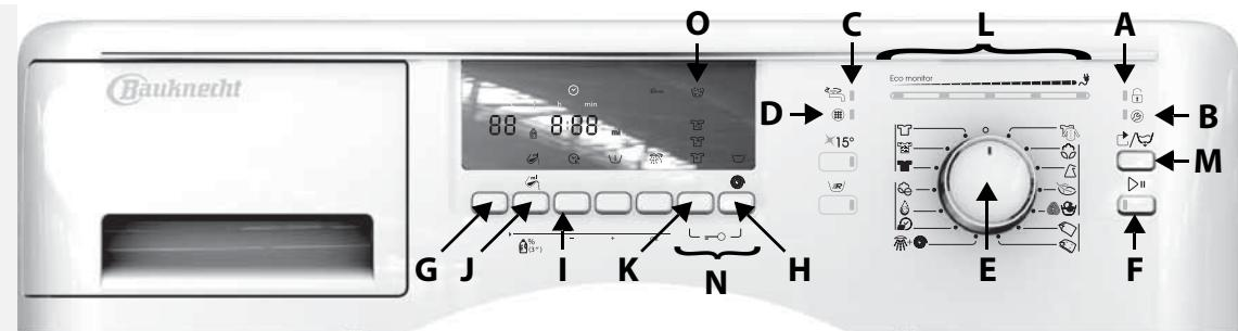
**E. Переключатель программ****F. Кнопка "Старт/Пауза"****G. Кнопка "Температура"****H. Кнопка "Отжим"** (вт.ч. "Задержка полоскания")**I. Кнопка "Завершить через"****J. Кнопка "Подсказка дозировки"****K. Кнопка "Степень загрязнения"****L. Эко-контроль****M. Кнопка "Сброс/Слив"****N. Комбинация кнопок для защиты от детей** =○**O. Индикатор избыточного количества дeterгента**
