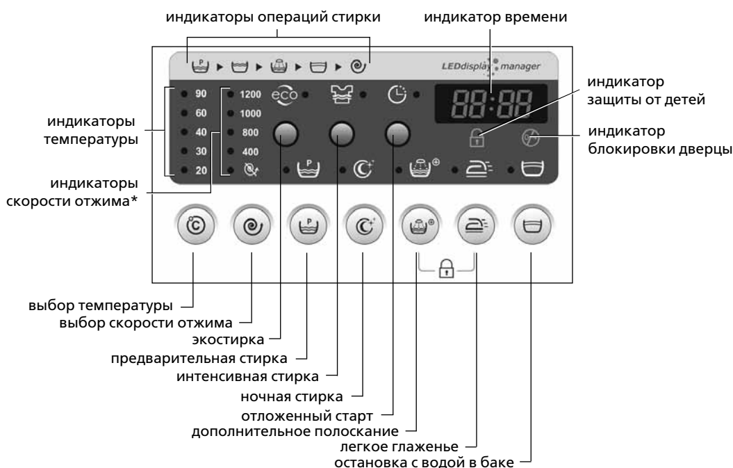
Рисунок 3 — Зоны индикации и кнопки выбора дополнительных функций
