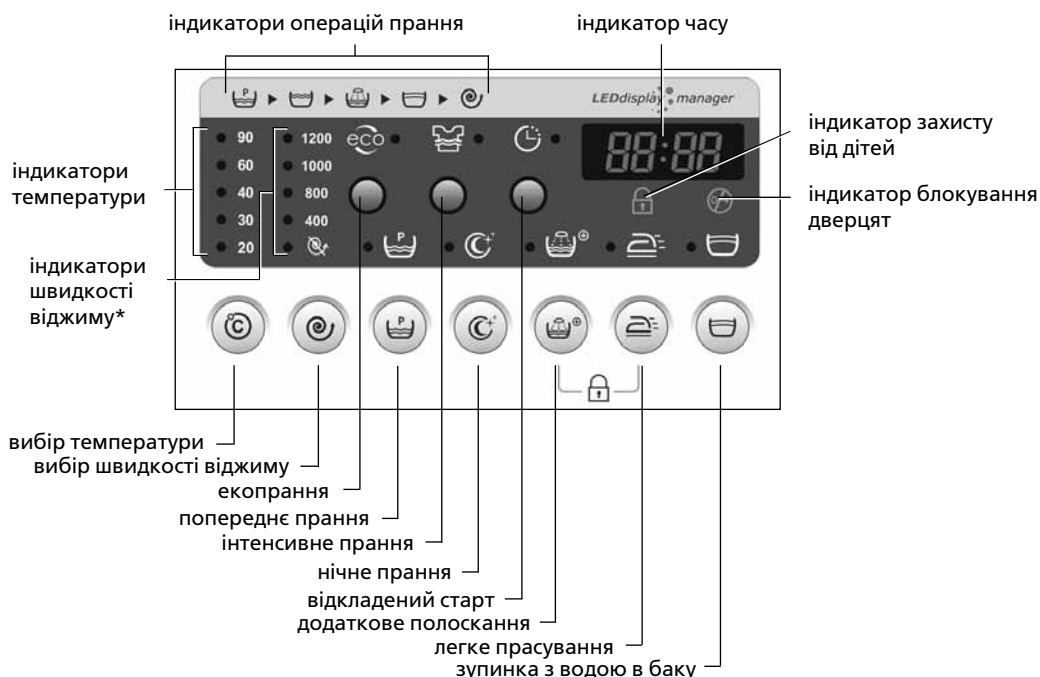
Рисунок 3 – Зони індикації і кнопки вибору додаткових функцій
