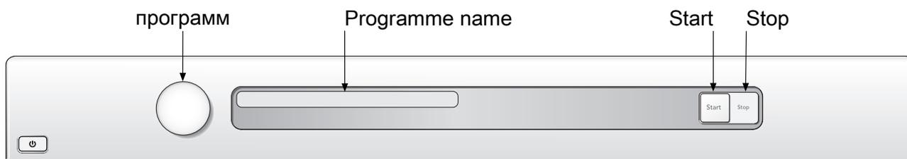
Для выбора программы поверните переключатель программ. Выбранная программа отображается на дисплее.
