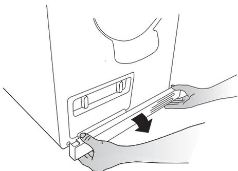
3. Откройте панель конденсатора, повернув обе рукоятки.
