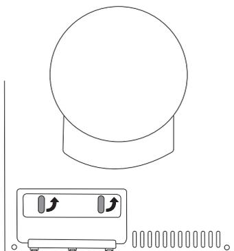
4. Выньте конденсатор и промойте его пластины, например, с помощью ручного душа. Не пытайтесь проникнуть в зазоры между пластинами, т. к. при этом можно повредить конденсатор. Не используйте для очистки заостренные металлические предметы.
