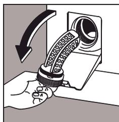
Полностью отвинтите крышку и выньте фильтр наружу. Промойте фильтр под струей воды. Затем вставьте фильтр назад и завинтите крышку по часовой стрелке.
