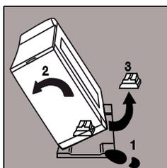
Снимите с машины всю упаковку. Наклоните машину на бок, выньте упаковку из-под мотора и поставьте машину вертикально.
