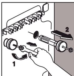
Гаечным ключом на 10 мм удалите два винта и две шпильки с задней панели машины.
