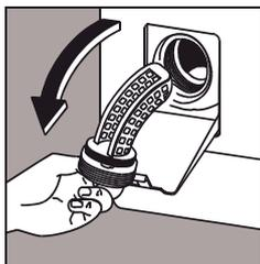
Полностью отвинтите крышку и выньте фильтр наружу. Промойте фильтр под струей воды. Затем вставьте фильтр назад и закрутите крышку по часовой стрелке.
