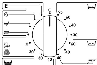
Установите селектор программ на выбранную программу; загораются индикаторы этапов, составляющих выбранную программу.
