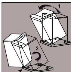
Наклоните машину назад, поверните ее на одном из ее углов на четверть оборота и выньте транспортировочное основание.
