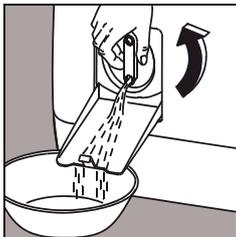
Подставьте под слив лоток. Поверните крышку против часовой стрелки, пока она не окажется в вертикальном положении, чтобы слить оставшуюся воду.
