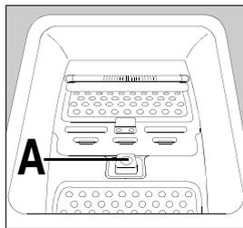
Предупреждение: перед закрыванием крышки стиральной машины убедитесь в том, что дверца барабана надежно закрыта:
