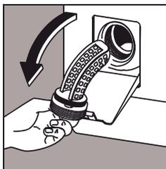
Полностью отвинтите крышку и выньте фильтр наружу. Промойте фильтр под струей воды. Затем вставьте фильтр назад и завинтите крышку по часовой стрелке.
