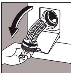
Полностью отвинтите крышку и выньте фильтр наружу. Промойте фильтр под струей воды. Затем вставьте фильтр назад и закрутите крышку по часовой стрелке.
