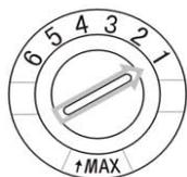
Определенное количество ополаскивающей жидкости используется во время последнего полоскания. Как и в случае с моющим средством, количество средства для полоскания зависит от жесткости воды. Слишком много средства приведет к чрезмерному образованию пены и разводам на Вашей посуде. Если вода в Вашем районе мягкая, Вам не нужно средство для полоскания. Если же нужно, то Вы можете разбавить его соответствующим количеством воды.
