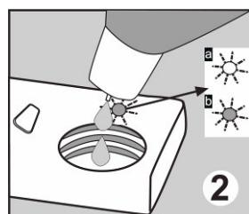
Для добавления ополаскивателя снимите колпачок отсека для ополаскивателя, повернув его. 1 Наполните отсек ополаскивателем, пока индикатор ополаскивателя не станет темным; установите колпачок на место и закройте, повернув
