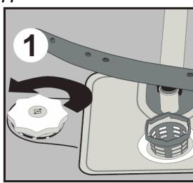
Используйте соль для смягчения: предназначенную специально для посудомоечных машин. Чтобы загрузить соль для смягчения, сначала извлеките нижнюю корзину, затем открутите колпачок отделения для соли, повернув его против часовой стрелки. Сначала заполните отделение 1 килограммами соли и водой 2 до уровня переливания. При наличии воронки 3 ее можно использовать для облегчения наполнения. Установите колпачок на место и завинтите его. После каждого 20-30 моек добавляйте в машину соль (прибл. 1 кг).
