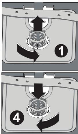
Чтобы снять и очистить блок фильтров, поверните его против часовой стрелки и, подняв вверх, выньте. **1**
