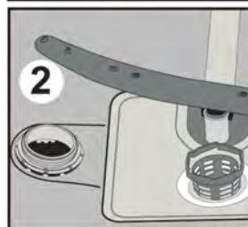
Используйте соль для смягчения, предназначенную специально для посудомоечных машин. Чтобы загрузить соль для смягчения, сначала извлеките нижнюю корзину, затем открутите колпачок отделения для соли, повернув его против часовой стрелки. Сначала заполните отделение 2 килограммами соли и водой до уровня переливания. При наличии воронки ее можно использовать для облегчения наполнения. Установите колпачок на место и завинтите его. После каждого 20-30 моек добавляйте в машину соль (прибл. 1,5 кг).
