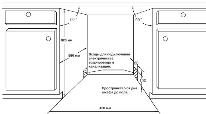
2. Если посудомоечная машина устанавливается в углу шкафа, необходимо обеспечить некоторое расстояние для открытия дверцы.
