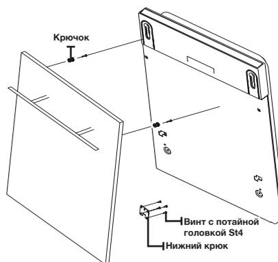
3. После расположения панели зафиксируйте ее на внешней дверце с помощью винтов и болтов.
