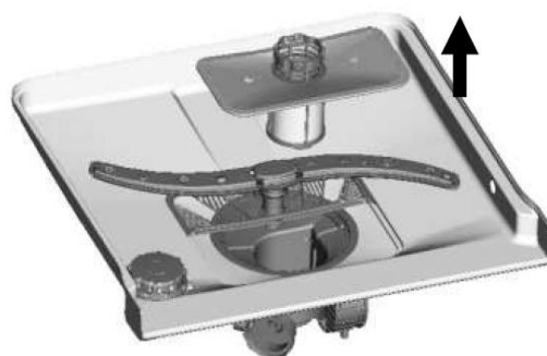
Шаг 2: Выньте фильтр движением вверх
