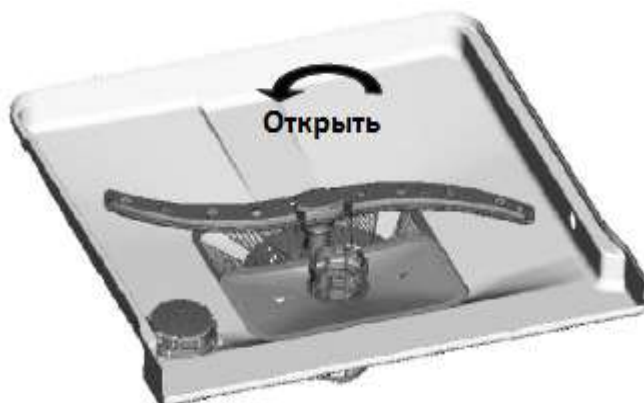
Шаг 1: Поверните фильтр против часовой стрелки.
