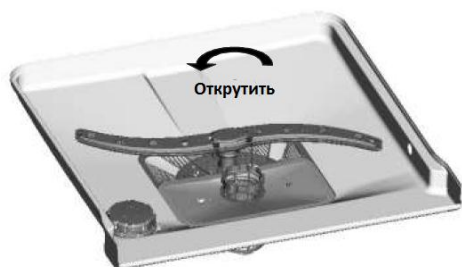
Шаг 1: Поверните фильтр против часовой стрелки.
