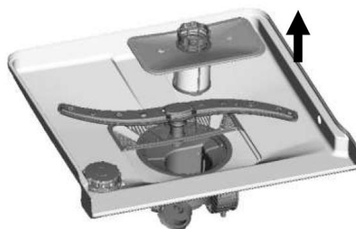
Шаг 2: Выньте фильтр движением вверх
