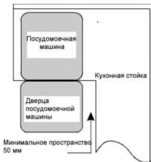
РИСУНОК 2 Минимальное пространство, необходимое для открытия двери.
