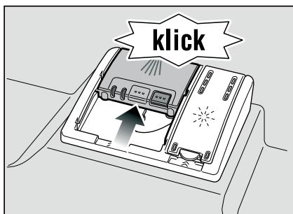
Камера с моющим средством открывается автоматически в зависимости от выбранной программы в самый подходящий для этого момента времени. Порошкообразное или жидкое моющее средство распределяется внутри машины и затем растворяется, таблетка падает в предназначенную для нее подставку и, находясь в ней, постепенно растворяется.
