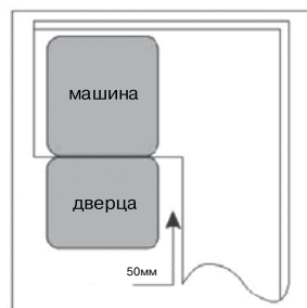
Рис. 2. Вид сверху. Минимальное пространство, когда дверца открыта.
