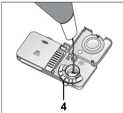
4. Вручную поверните регулятор количества ополаскивателя в положение от 1 до 6 (4). При наличии следов на посуде после мойки следует повысить уровень, а если при вытирании остаются синие следы, уровень необходимо понизить. Заводская настройка по умолчанию – положение 4.
