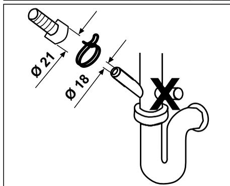
Сливной шланг длиннее 4 метров снижает качество мытья. Подсоедините сливной шланг к сливной трубе, не сгибая его. Надежно прикрепите сливной шланг к сливной трубе во избежание его смещения во время работы машины.
