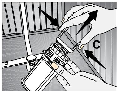
4. Очистите все три фильтра под водой из-под крана с помощью щетки.
