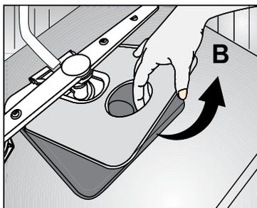
3. Нажмите на две защелки на фильтре грубой очистки и отсоедините его от блока (С).
