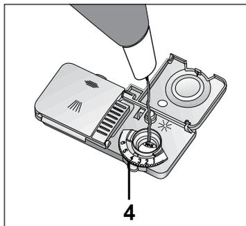
4. Вручную поверните регулятор количества ополаскивателя в
