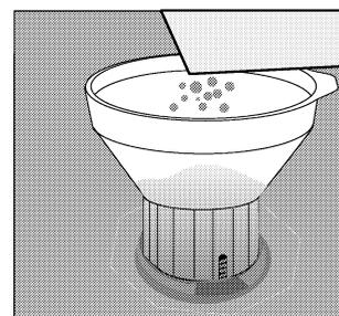
Во время работы посудомоечной машины умягчитель воды заполняется водой. Следует засыпать в машину умягчающую соль непосредственно перед включением программы мойки посуды.
