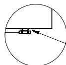
\* Если высота установки составляет 820-821 мм, отвинтите стопорные гайки.
